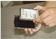
Tháo ổ đĩa cứng cũ ra khỏi hộp, đặt vào cái mới, và lặp lại các bước trên để cái đợt nò.
