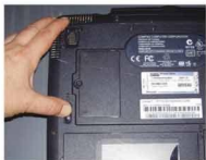
Một nút trượt sẽ mở khoang pin ra ở nhiều máy tính xách tay.
