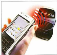
Sử dụng công nghệ NFC, bạn có thể thực hiện thanh toán bán hàng bằng cách vẩy điện thoại di động gần cổng thanh toán.
