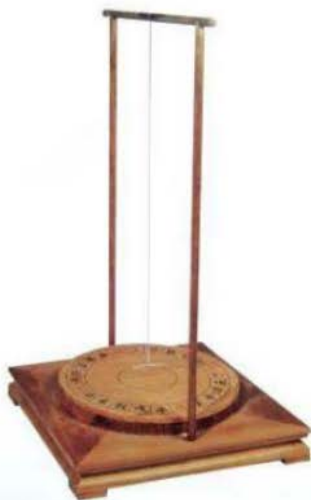
Kim chỉ nam lư huyền pháp (mô hình). Dùng sáo gắn một sợi tơ tằm vào chính giữ kim từ, kim từ ở trung tâm của bàn sẽ hướng lên trên, lúc không động, hai đầu chỉ về hai hướng Nam Bắc.
