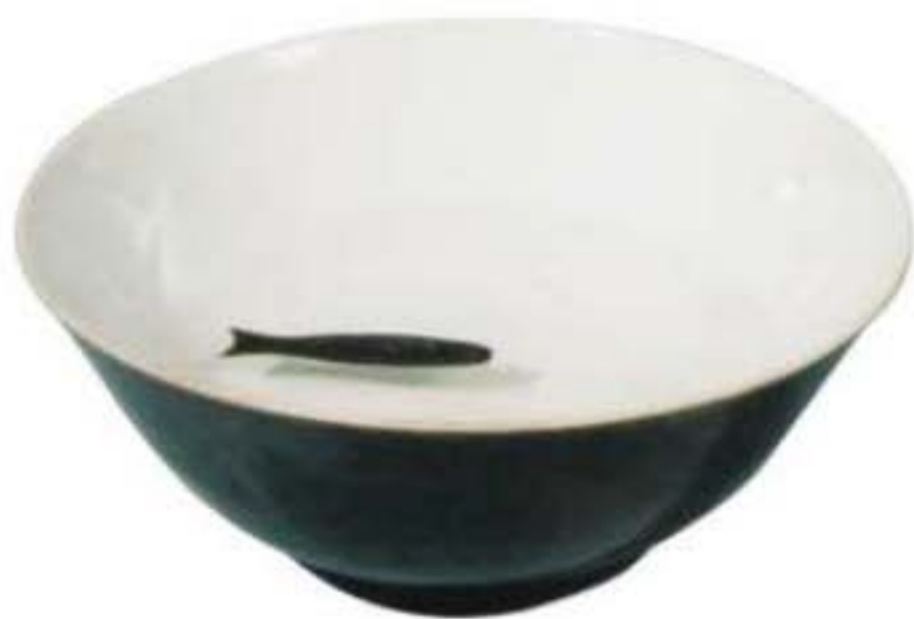
Kim chỉ nam thủy phù pháp (mô hình). Đặt nằm từ ngư trên mặt nước trong bát, lúc bình lặng, đầu và đuôi cá chỉ về hai hướng Nam Bắc.
