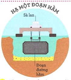
Những đoạn ống bê tông đúc sản được vận chuyển tới vị trí cần lấp đặt và hạ thấp xuống dưới đáy. Một cần trục thủy lực sẽ kéo từng đoạn ống mới sát gần với đoạn liền kề để tạo thành một mạch kín nước.
