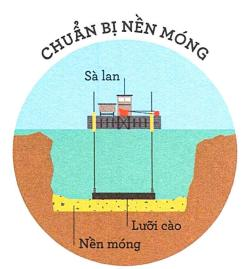
2 Đội thi công đổ sẵn dưới đáy của con hào một nền móng gồm cát và cốt liệu. Móng được dàn phẳng bằng một lưỡi cào để đảm bảo tạo ra một mặt để bằng phẳng đều nhau cho các đoạn đường hầm.
