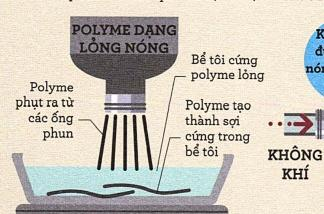
Sản xuất sợi polyme Vật liệu thô được sử dụng tạo ra sợi carbon là một loại polyme. Khoảng 90% các loại sợi carbon được tạo ra từ loại polyme có tên polyacrylonitrile (PAN). Ở công đoạn đầu tiên, polyme PAN được làm thành dạng sợi dài.
