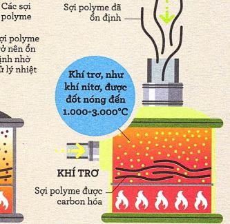
Sợi được carbon hóa Sợi polyme sau đó được nung nóng tới nhiệt độ cao hơn trong một lò cao giàu khí trơ và không có oxy để ngăn sợi không bị đốt cháy. Hệ quả là sợi mất đi các nguyên tử phi carbon và trở thành sợi được carbon hóa.
